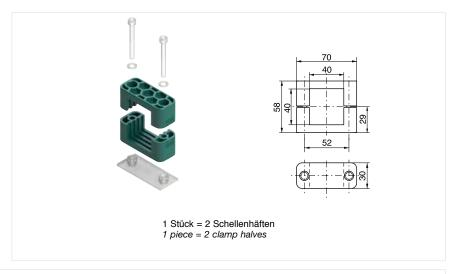
Befestigungsschelle für Näherungsschalter nach EN 50 025 und 50 037 mit quadratischem Gehäuse 40 x 40 mm.
